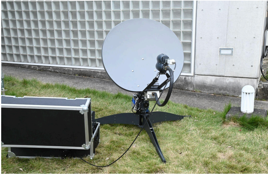
VSAT utilisé pour les tests Universal NTN (c) SKY Perfect JSAT Corporation
